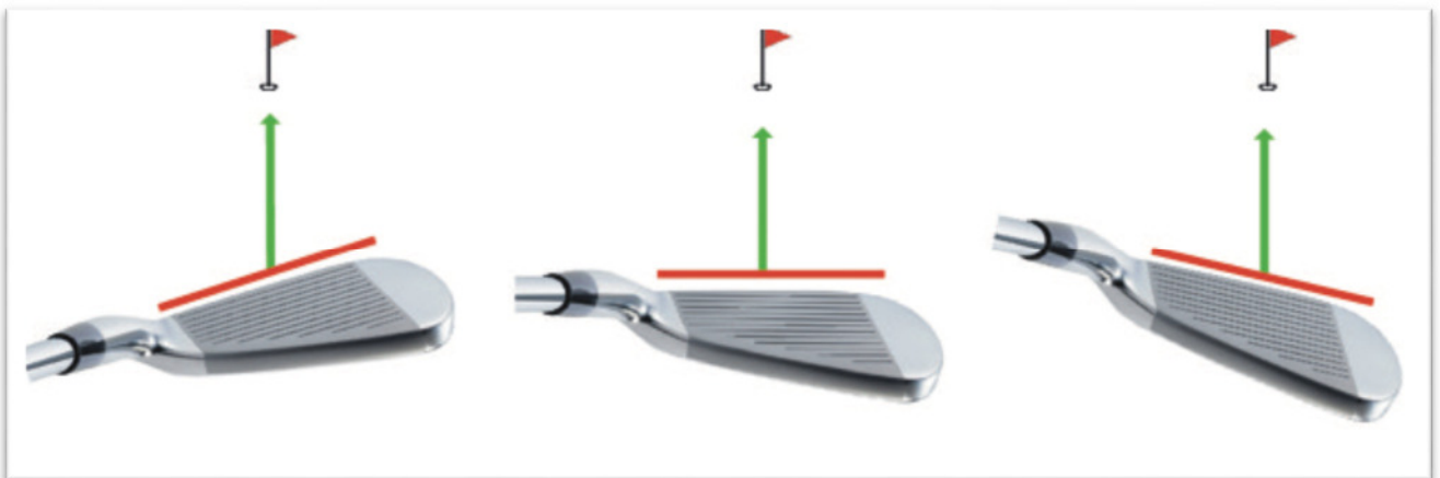
Abbildung 3 (v.l.n.r.): Geschlossene Schlagflächenstellung, gerade Schlagflächenstellung, offene Schlagflächenstellung.
