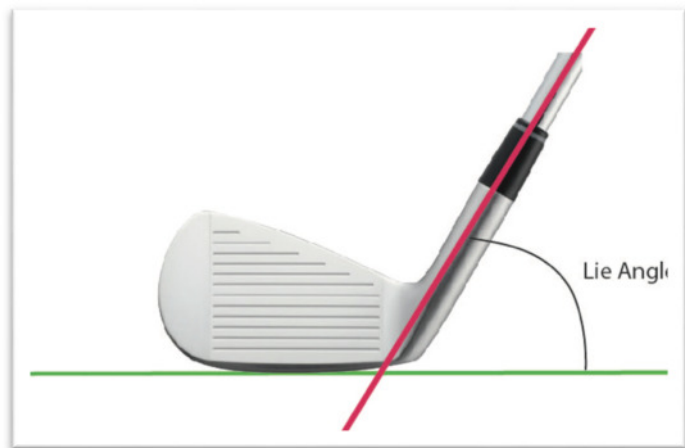
Abbildung 6: Der statische Lie wird zwischen Schaft und Boden gemessen.
