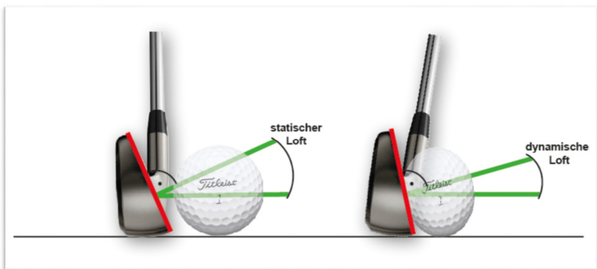
Abbildung 4: Statischer und dynamischer Loft.
